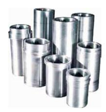
Предназначены для изменения подачи и давления при работе поршней в среде промывочной жидкости. Цилиндровая втулка представляет собой сменный рабочий цилиндр бурового насоса. Рабочая внутренняя поверхность втулок имеет упрочненный слой глубиной не менее 2 мм с твердостью HRC60...64 и зеркальной поверхности 0,8. Материал ст 70 ГОСТ14959-79.
